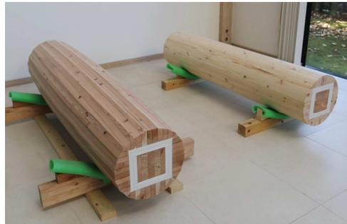
クールウッドは当社が開発した木質耐火部材であり、1 時間・2 時間耐火で国土交通大臣認定を取得しています。柱と梁は、核となる木材（荷重支持部材）を石こうボード（燃え止まり層）で囲み、外側をさらに木材（表面材）で覆っているため、木の温もりを活かした建物をつくることができます。
