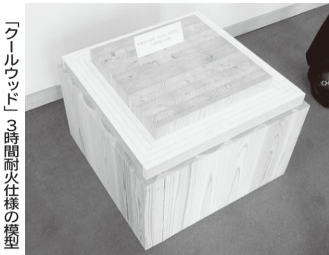
「クールウッド」3時間耐火仕様の模型
